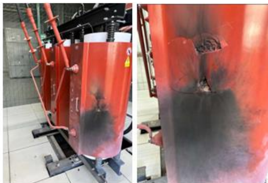
Figura 1 – Transformador Auxiliar TSA1 da Subestação Campinas avariado – 10/06/2023
